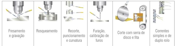
**Características:** MQL - Mínima Quantidade de Lubrificação. Reduz até 90% o consumo de fluido de corte, aumenta até 25% a vida útil das ferramentas, mantém a máquina, ambiente e cavacos mais limpos.
