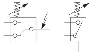
Pressostato com 1 e 2 contatos
